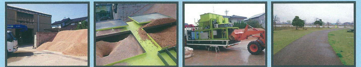
リサイクル材による舗装コンクリート
